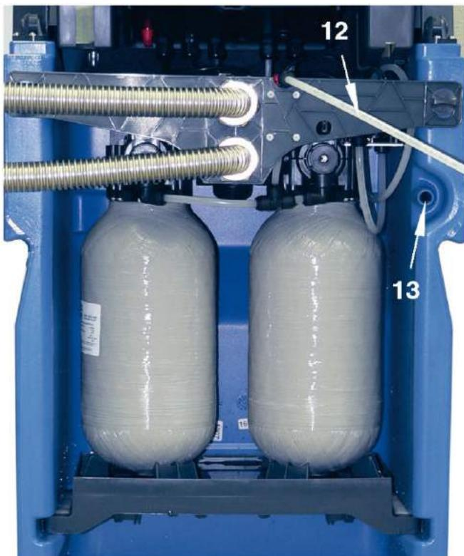
Расположить дренажный шланг для промывочной воды (12) под наклоном к системе канализации (дренажа) и закрепить конец фиксатором (материалом), поставляемым для предотвращения колебаний под давлением.
